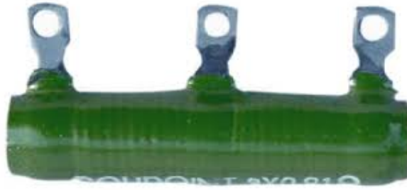
ภาพที่ 2.18 ตัวต้านทานไฟฟ้าแบบขดลวดพันชนิดเลือกค่าได้
