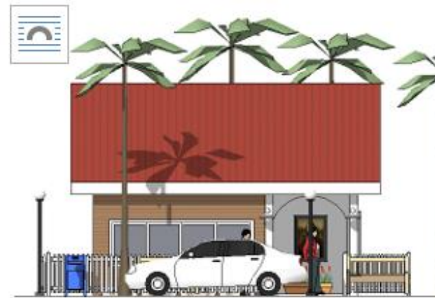
มุมมองด้านหน้า หรือ Front View แบบ Parallel Projection
