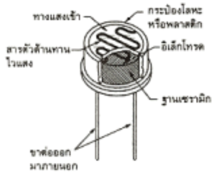
รูปที่ 2.6 โครงสร้างภายในแอลดีอาร์(LDR)
