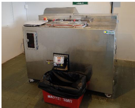
ภาพที่ 2.7 เครื่องย่อยขยะอินทรีย์ให้เป็นปุ๋ย ที่มา: Sortcorp
