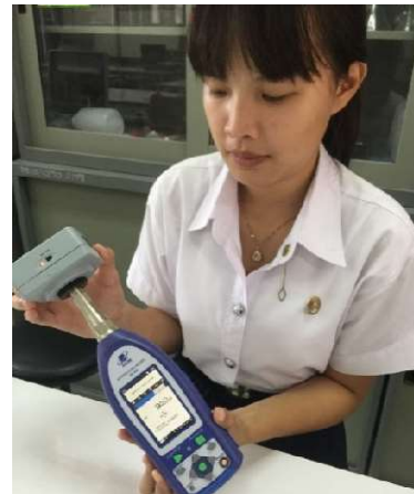
ภาพที่ 4.11 การสวมไมโครโฟนเข้าไปใน Coupler ของเครื่อง Sound Calibrator
