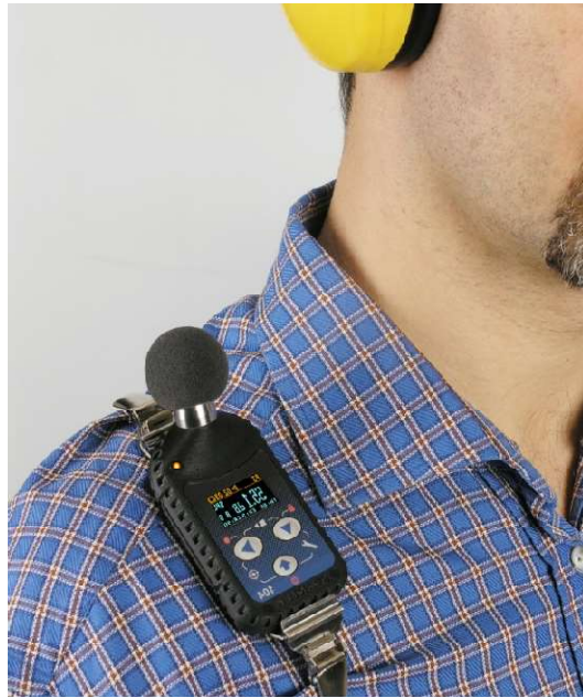
ภาพที่ 4.15 การติดตั้งเครื่องวัดปริมาณเสียงสะสม
