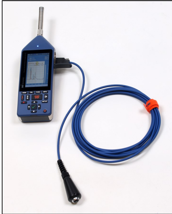
ภาพที่ 4.5 กระทบหรือกระแทก (Impulse or Impact Noise Meter)
