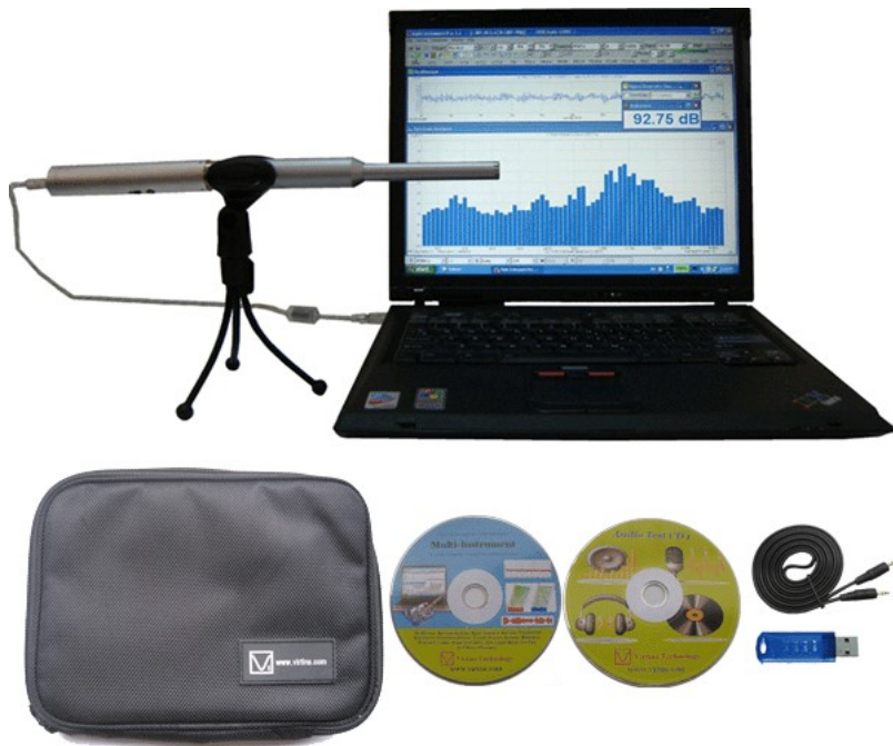
ภาพที่ 4.7 เครื่องวิเคราะห์ความถี่เสียง (Frequency Analyzer)
