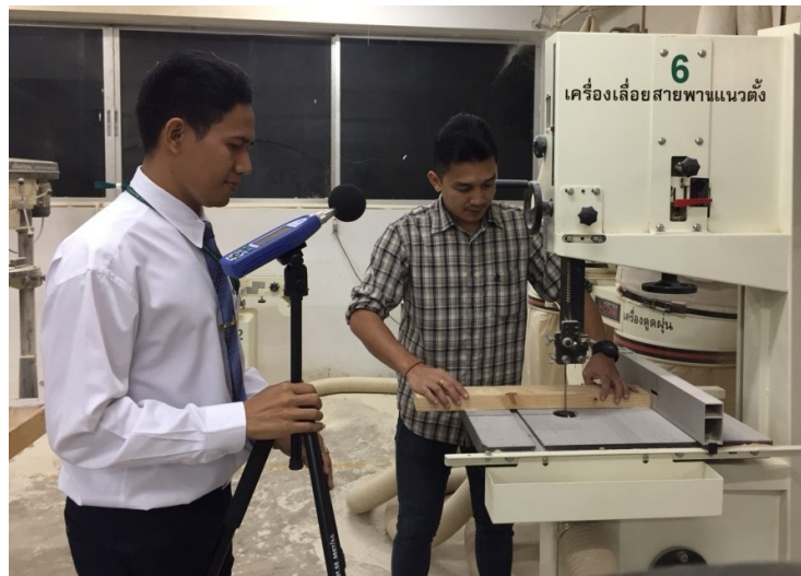
ภาพที่ 4.13 การติดตั้งเครื่องวัดเสียงกับขาตั้งที่ความสูงระหว่าง 120-150 เซนติเมตร ที่มา: ห้องปฏิบัติการ 4257, (2560)
