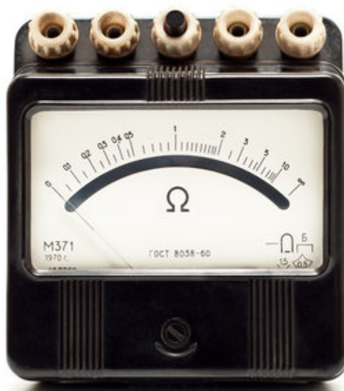
รูปที่ 2.7 โอห์มมิเตอร์
