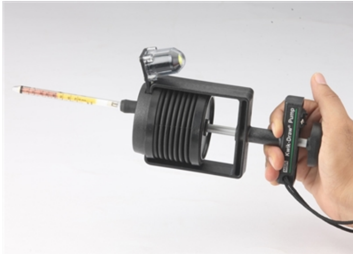
ภาพที่ 2.4 เบลโลว์ปั๊ม (Bellow pump) ของ ICON ที่มา: ICON Safety, (2559)
