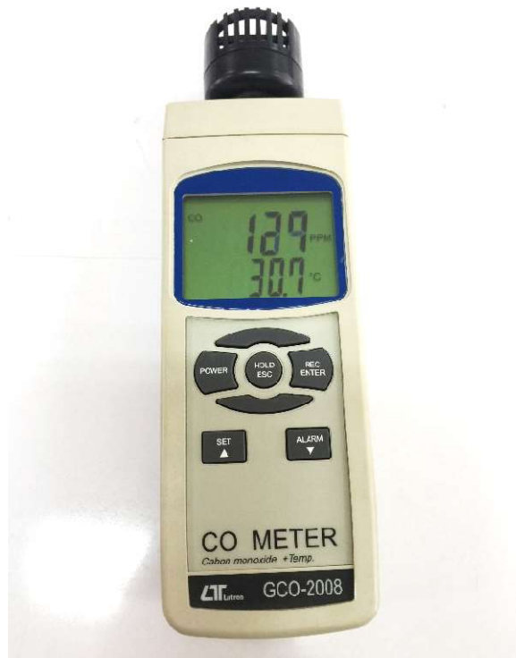
ภาพที่ 2.14 เครื่องตรวจวัดก๊าซคาร์บอนมอนอกไซด์ ที่มา: ห้องปฏิบัติการ 4257, (2560)
