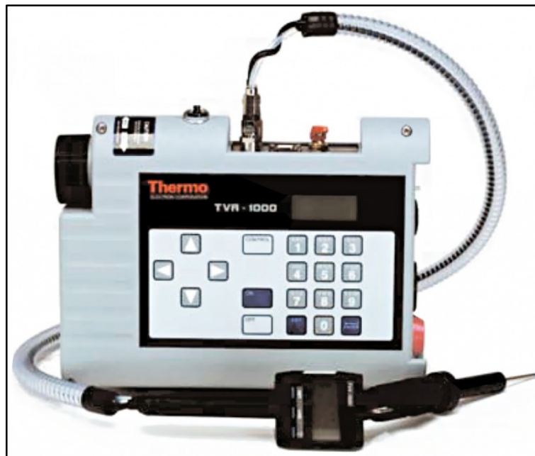
ภาพที่ 2.22 เครื่องตรวจวัดแบบเฟรมไอออนไนเซชัน
