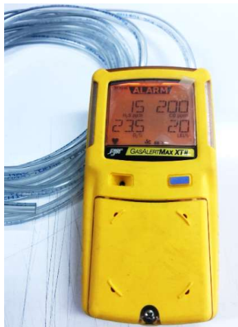
ภาพที่ 2.12 เครื่องวัดปริมาณออกซิเจนและก๊าซไวไฟในพื้นที่อับอากาศ ที่มา: ห้องปฏิบัติการ 4257, (2560)
