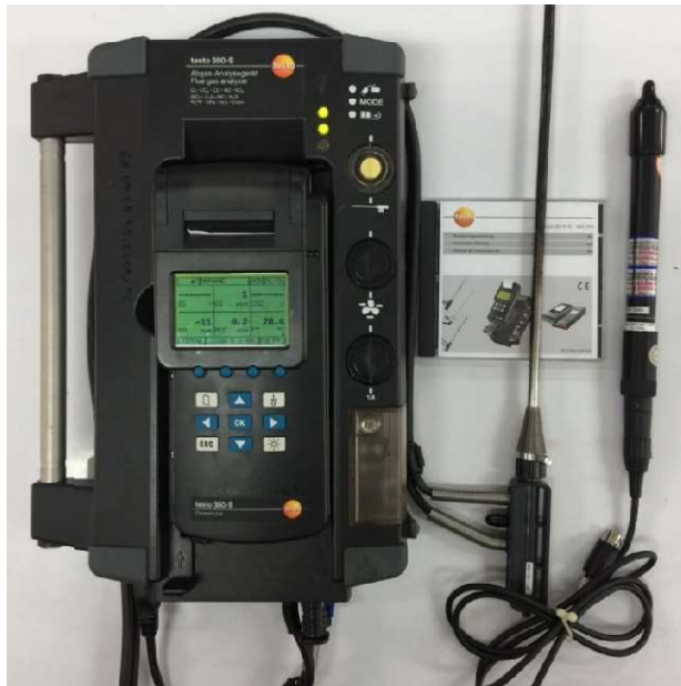
ภาพที่ 2.11 เครื่องตรวจวัดมลพิษอากาศจากการเผาไหม้ ที่มา: ห้องปฏิบัติการ 4257, (2560)
