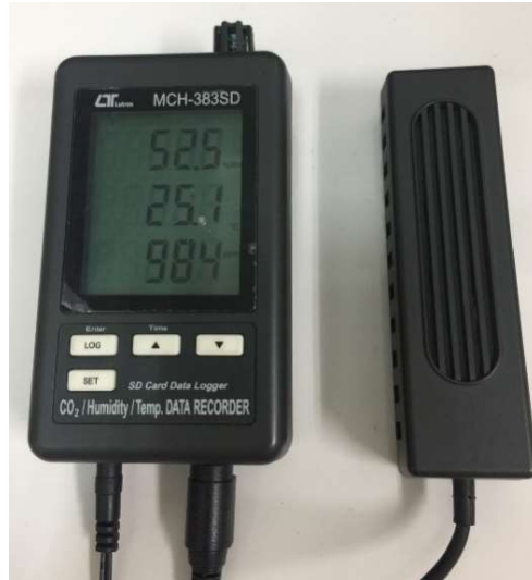
ภาพที่ 2.13 เครื่องวัดก๊าซคาร์บอนไดออกไซด์ในบรรยากาศ ที่มา: ห้องปฏิบัติการ 4257, (2560)
