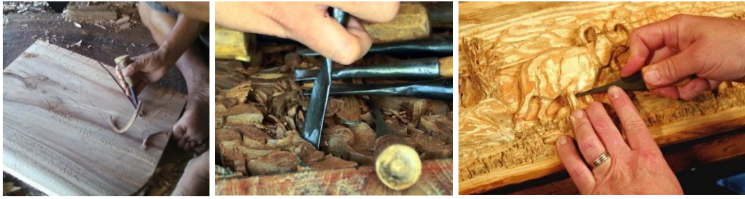
รูปที่ 10.2 ขั้นตอนและวิธีการทำงานไม้แกะสลัก
