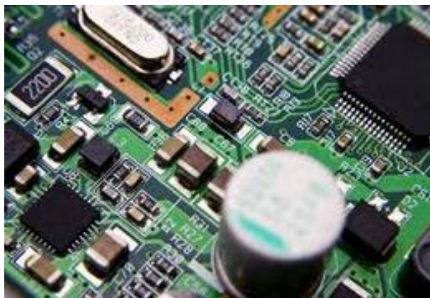
รูปที่ 8.14 แผงวงจรไฟฟ้าจะใช้อัลไคด์เป็นสารเคลือบชิ้นงาน
