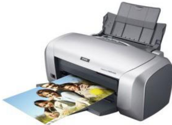
รูปที่ 8.2 เครื่องปริ้นเตอร์ทำจากโพลีโพรพิลีน
