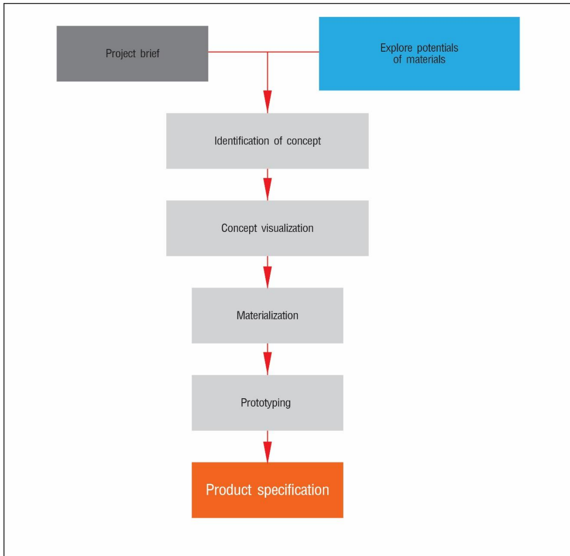
รูปที่ 9.10 แผนภาพแสดงขั้นตอนการออกแบบผลิตภัณฑ์ตามแนวทางการออกแบบรูปทรงโดยอิงวัสดุ “Form follows material”
