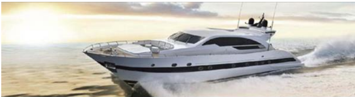
รูปที่ 8.12 เรือยอชต์ทำจากโพลีเอสเตอร์ผสมใยแก้ว
