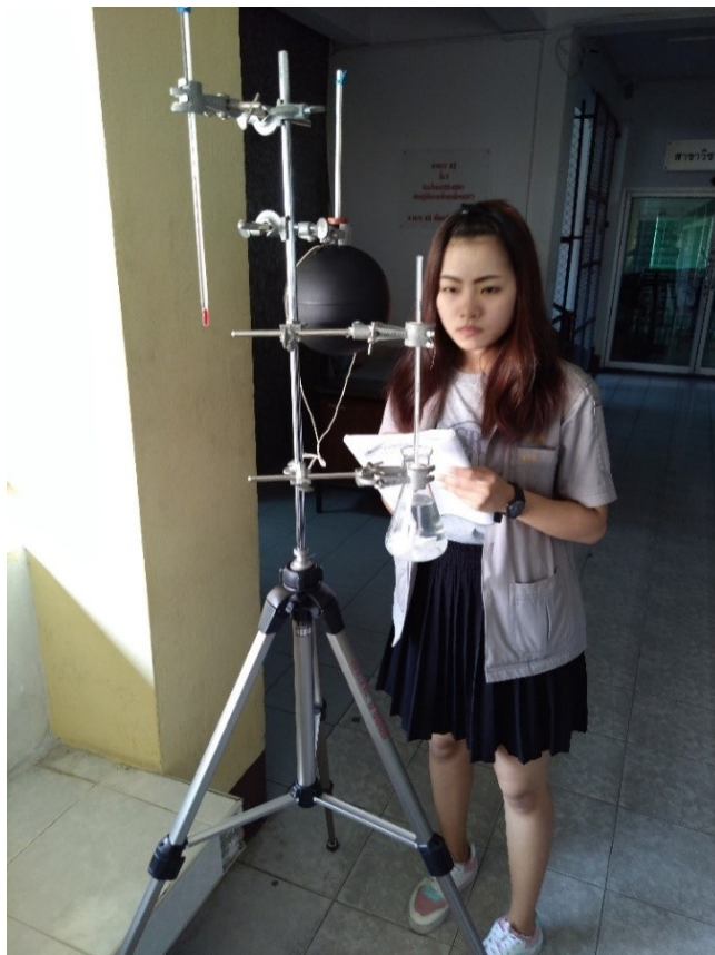
ภาพที่ 6.9 การติดตั้งและตรวจวัดค่าดัชนีระดับความร้อน ที่มา: นักศึกษาสาขาวิชาเทคโนโลยีความปลอดภัยและอาชีวอนามัย, (2560)
