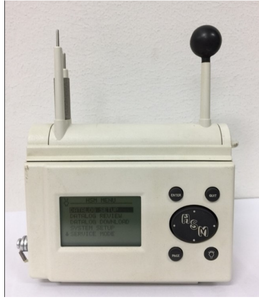
ภาพที่ 6.10 เครื่องวัดความร้อนชนิดอ่านค่าได้โดยตรง ที่มา: ห้องปฏิบัติการ 4257, (2560)
