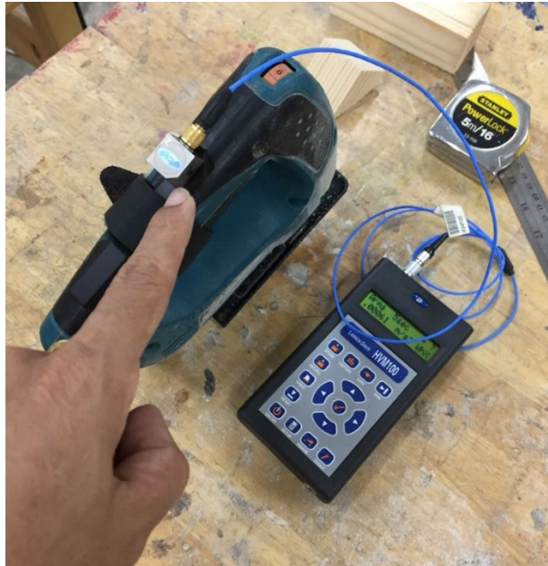
ภาพที่ 9.8 การติดตั้งหัววัดความสั่นสะเทือนที่ด้ามจับของเครื่องเลื่อยจิ๊กซอว์ ที่มา: ห้องปฏิบัติการ 4257, (2560)
