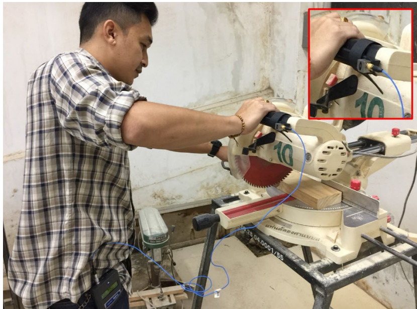
ภาพที่ 9.9 การติดตั้งหัววัดความสั่นสะเทือนที่ด้ามจับของเครื่องตัดชนิดปรับองศา ที่มา: ห้องปฏิบัติการ 4257, (2560)
