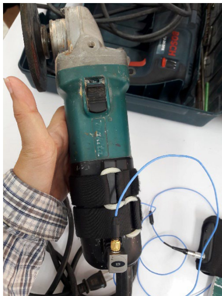
ภาพที่ 9.10 การติดตั้งหัววัดความสั่นสะเทือนที่ด้ามจับของเครื่องเจียร ที่มา: ห้องปฏิบัติการ 4257, (2560)
