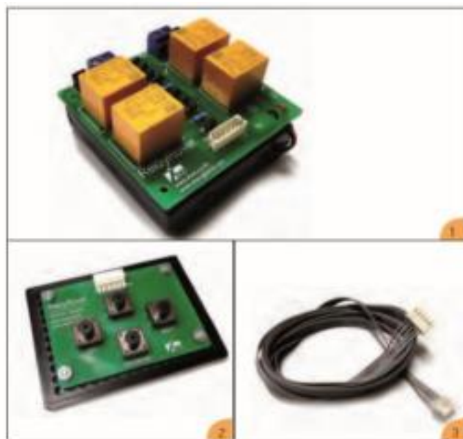
รูปที่ 8.5 แสดงชุดควบคุมของรถหุ่นยนต์บังคับมือควบคุมด้วยรีเลย์
