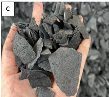
รูปที่ 2 การผลิตถ่าน A เศษกะลามะพร้าว B ให้ความร้อนเตาปฏิกรณ์ และ C ถ่านไบโอชาร์
