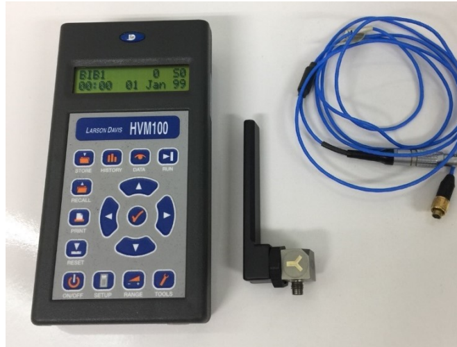
ภาพที่ 9.1 ส่วนประกอบของเครื่องมือวัดความสั่นสะเทือน ที่มา: ห้องปฏิบัติการ 4257, (2560)
