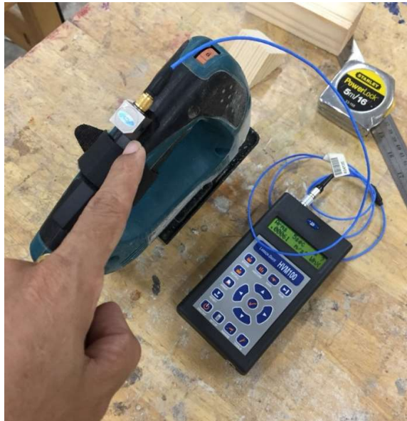
ภาพที่ 9.8 การติดตั้งหัววัดความสั่นสะเทือนที่ด้ามจับของเครื่องเลื่อยจิ๊กซอร์ว ที่มา: ห้องปฏิบัติการ 4257, (2560)
