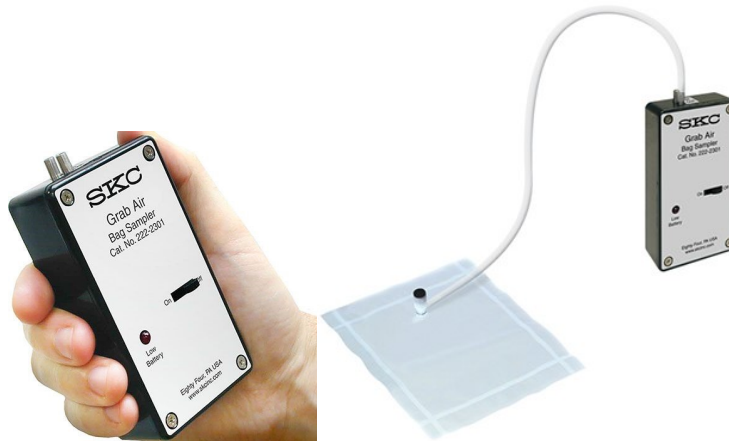
ภาพที่ 10.12 การประกอบอุปกรณ์เก็บตัวอย่างอากาศด้วยถุงเก็บตัวอย่างอากาศ ที่มา : SKC Ltd., (2017)
