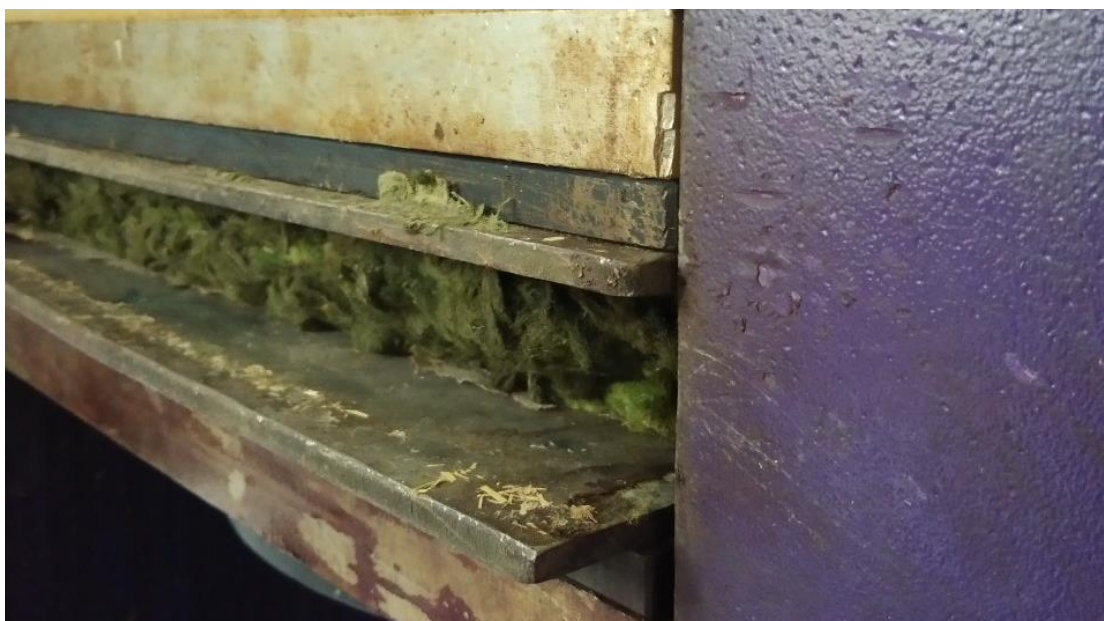
ภาพที่ 4.26 ภาพแสดงการอัดความร้อนด้วยเครื่องอัดแรงสูง
