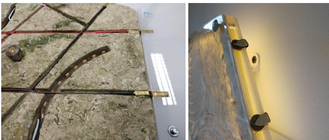
ภาพที่ 5.4 ภาพแสดงการใช้ขั้วทองเหลือง
