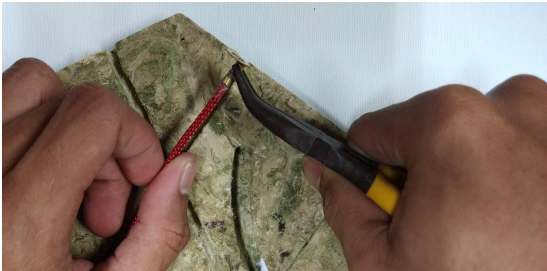
ภาพที่ 4.29 ภาพแสดงการต่อไฟแผ่นอัดสาหร่าย
