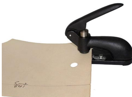
ภาพที่ 1.38 วิธีการใช้เครื่องเจาะรูขนาดใหญ่ (Pattern Punch)
