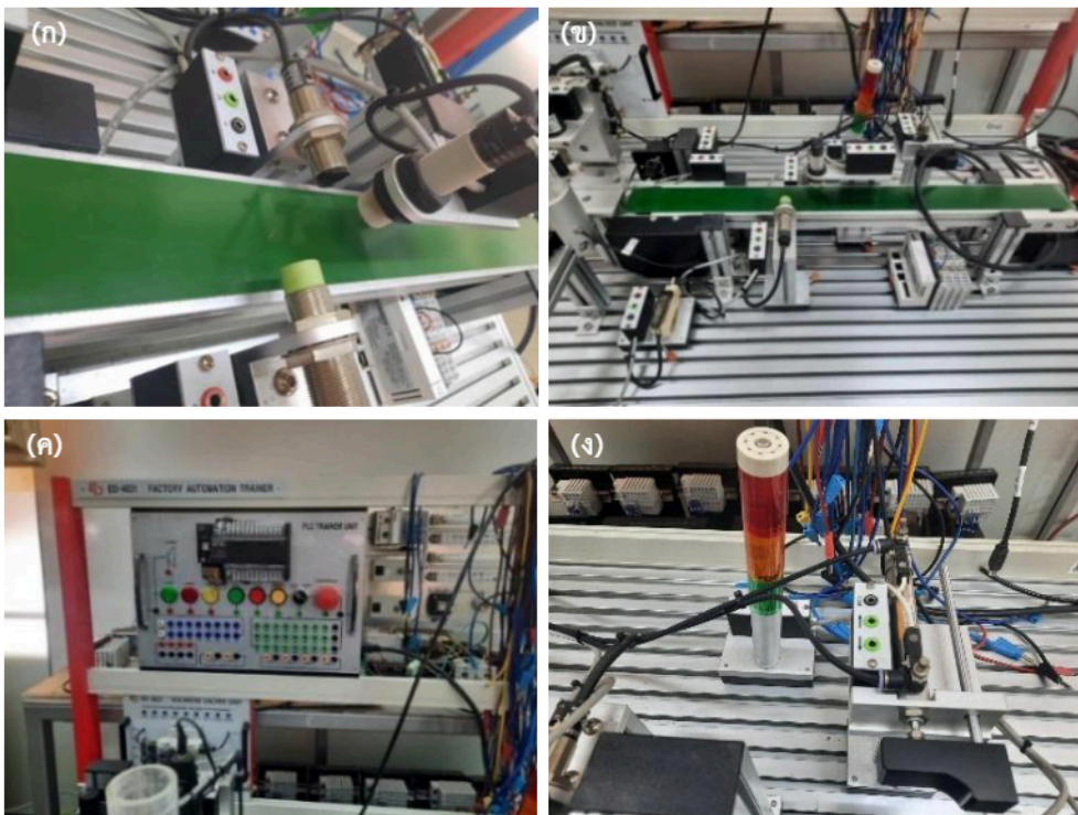
ภาพที่ 1 การเตรียมและติดตั้งสายพาน (ก) สายพานที่ใช้ในการวิจัย (ข) การเชื่อมต่อระหว่างอุปกรณ์กับสายพาน (ค) อุปกรณ์ในการสั่งการและควบคุมสายพาน (ง) ไฟสัญญาณแจ้งเตือนระบบ
