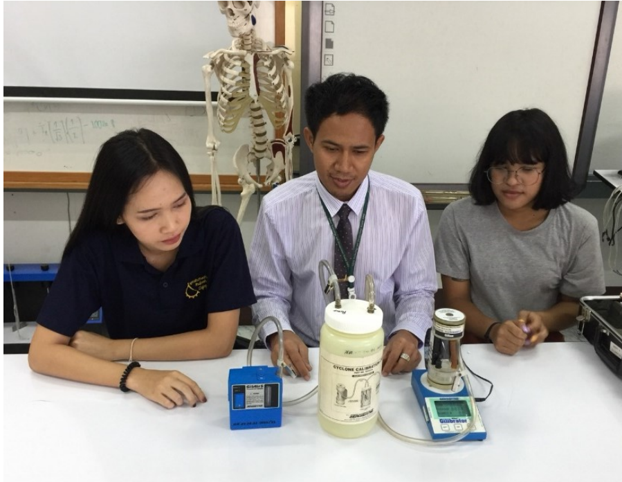
ภาพที่ 7.17 การสอบเทียบเครื่องมือสำหรับ PM10 วิธี Electronic Bubble Meter ที่มา: ห้องปฏิบัติการ 4257, (2560)
