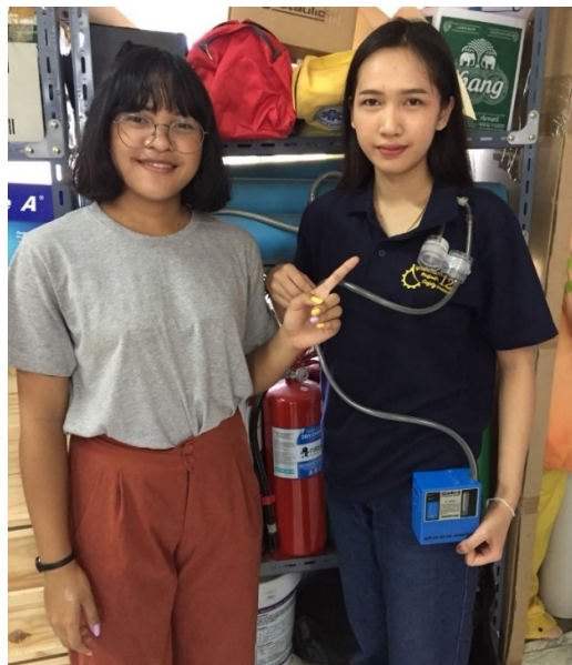
ภาพที่ 7.12 การติดตั้งอุปกรณ์เก็บอนุภาคไว้ที่ตัวบุคคล ที่มา: นักศึกษาสาขาวิชาเทคโนโลยีความปลอดภัยและอาชีวอนามัย, (2560)
