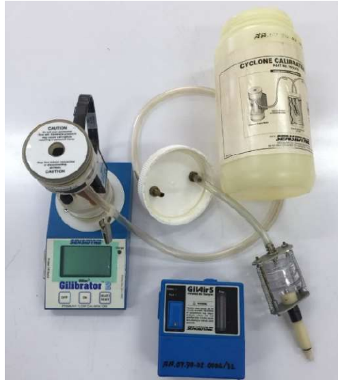
ภาพที่ 7.11 เครื่องสอบเทียบชนิด Electronic Bubble Meter และ Calibration JAR ที่มา: ห้องปฏิบัติการ 4257, (2560)
