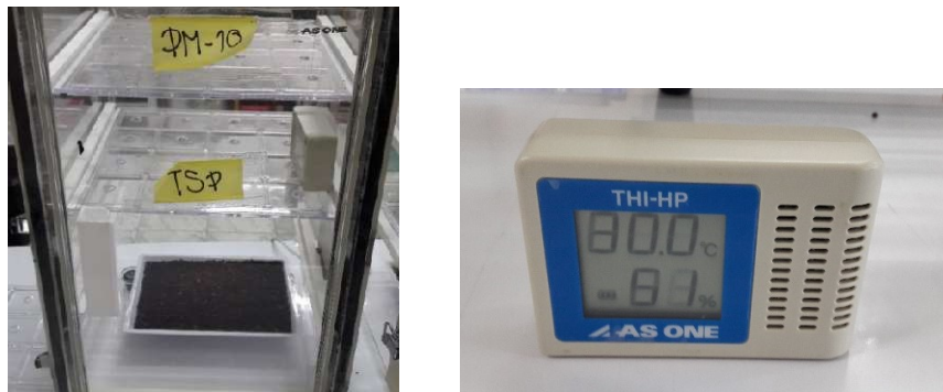
ภาพที่ 7.10 ตู้ดูดความชื้นและเครื่องวัดความชื้น ที่มา: ห้องปฏิบัติการ 4257, (2560)
