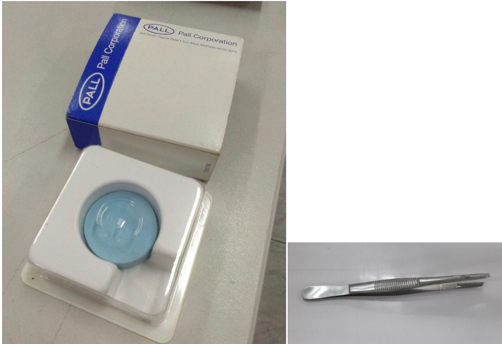
ภาพที่ 7.8 กระจาดุกรองชนิดโพลีไวนิลคลอไรด์และปากคีบ ที่มา: ห้องปฏิบัติการ 4257, (2560)
