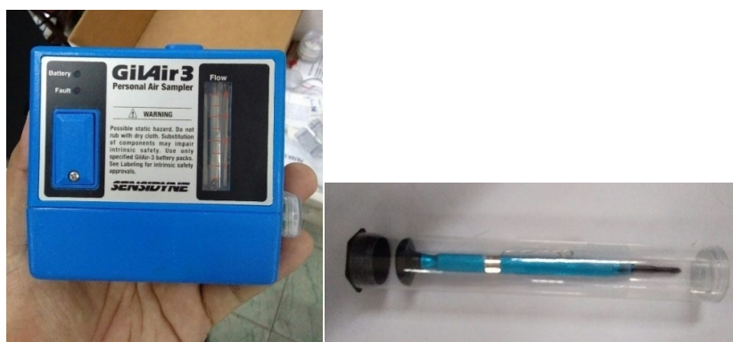
ภาพที่ 7.7 ปั๊มดูดอากาศวัดอัตราการไหลของอากาศแบบโรตารีมิเตอร์และไขควงปรับตั้ง ที่มา: ห้องปฏิบัติการ 4257, (2560)
