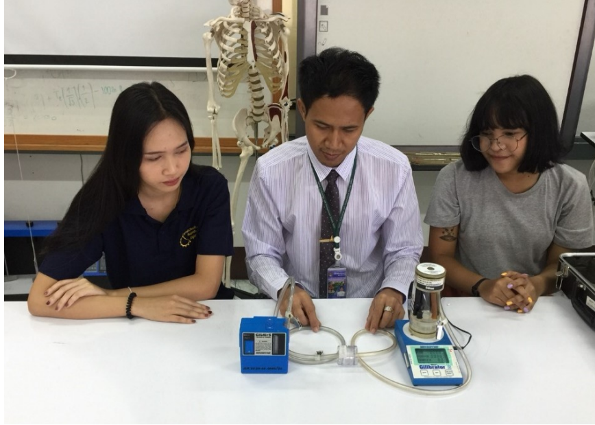
ภาพที่ 7.15 การสอบเทียบเครื่องมือสำหรับ TSP วิธี Electronic Bubble Meter ที่มา: ห้องปฏิบัติการ 4257, (2560)
