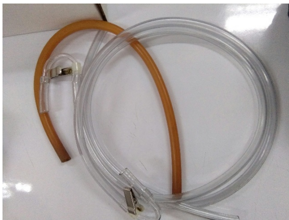
ภาพที่ 7.6 ส่วนเชื่อมต่อประกอบด้วยข้อต่อและสายพลาสติก ที่มา: ห้องปฏิบัติการ 4257, (2560)
