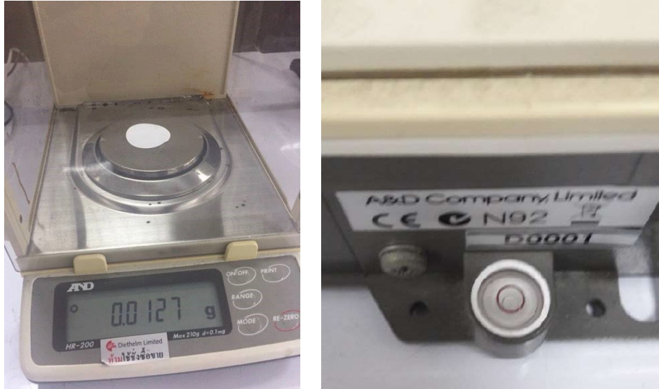
ภาพที่ 7.9 เครื่องชั่งไฟฟ้าและตำแหน่งปรับระดับหลังเครื่อง ที่มา: ห้องปฏิบัติการ 4257, (2560)
