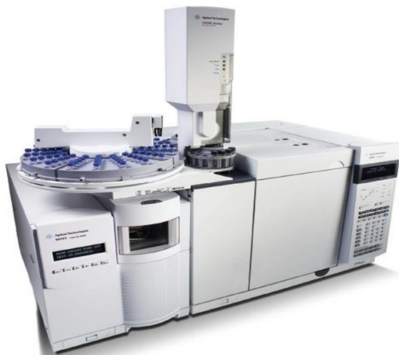
ภาพที่ 1.2 เครื่องแก๊สโครมาโทกราฟี ที่มา: แม้น อมรสิทธิ์ และคณะ, (2555)
