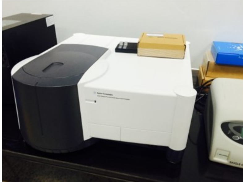
ภาพที่ 1.6 เครื่องวัดการเรืองแสงของสาร ที่มา: QES (THAILAND), (2560)
