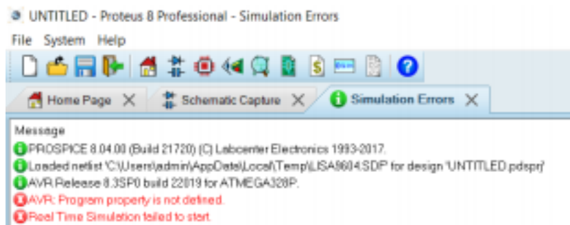
รูปที่ 15.7 ผลการจำลองการทำงานของวงจรการแสดงผล LED ด้วย โลบาร์รี่ของวงจรอาดูยโน้รุ่น UNO R3
