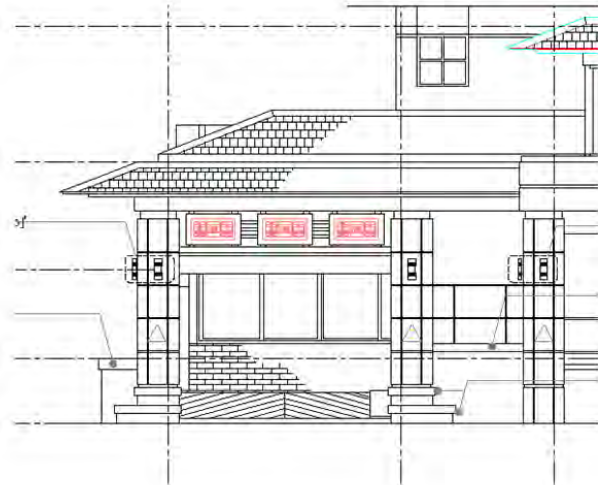
รูปที่ 8.24 การแสดงสัญลักษณ์วัสดุที่ใช้ในรูปด้าน
