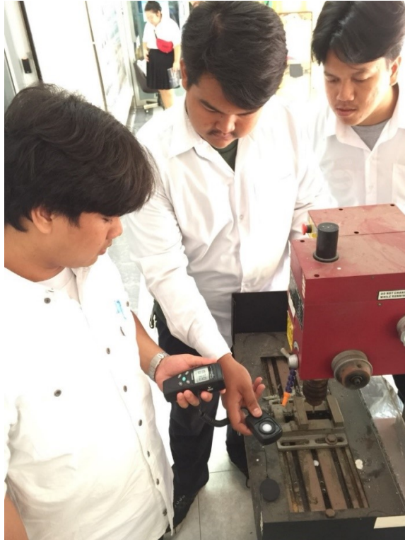
ภาพที่ 3.22 การตรวจวัดแสงแบบเฉพาะจุด ที่มา: นักศึกษาสาขาวิชาเทคโนโลยีความปลอดภัยและอาชีวอนามัย, (2560)
