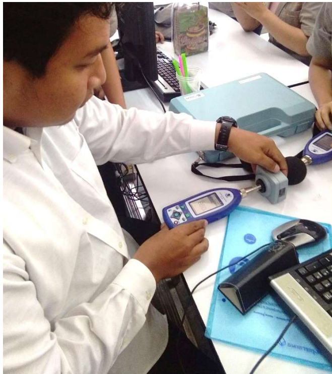
ภาพที่ 5.3 การสวมไมโครโฟนเข้าไปใน Coupler ของเครื่อง Sound Calibrator นักศึกษาสาขาวิชาเทคโนโลยีความปลอดภัยและอาชีวอนามัย, (2560)
