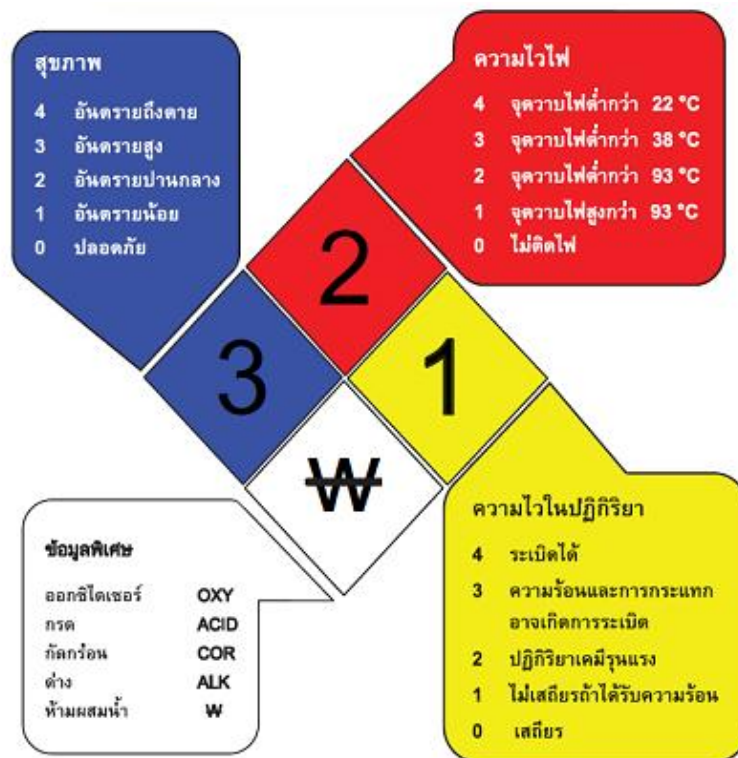
ภาพที่ 8.9 แสดงตัวอย่างความรุนแรงของสารเคมีมาตรฐาน NFPA ที่มา (สมาคมส่งเสริมความปลอดภัยและอนามัยในการทำงาน (ประเทศไทย), 2553 : ออนไลน์)
