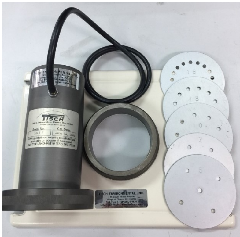
ภาพที่ 8.20 ชุดสอบเทียบ Orifice Flow Rate Transfer Standard ประกอบด้วยกระบอกโลหะ และแผ่นต้านทานการไหลของอากาศจำนวน 5 แผ่น
