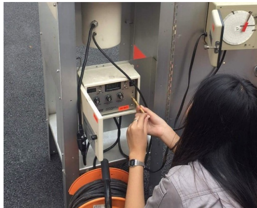
ภาพที่ 8.17 ปรับอัตราการไหลของอากาศ ที่มา: นักศึกษาสาขาวิชาเทคโนโลยีความปลอดภัยและอาชีวอนามัย, (2560)
