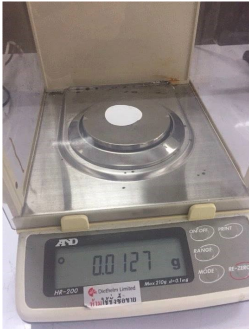
ภาพที่ 8.10 เครื่องชั่งไฟฟ้าและตำแหน่งปรับระดับหลังเครื่อง ที่มา: ห้องปฏิบัติการ 4257, (2560)
