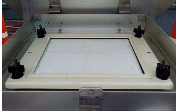
ภาพที่ 8.16 การติดตั้งกระตาดากรองลงบนตะแกรงของเครื่องเก็บตัวอย่าง ที่มา: นักศึกษาสาขาวิชาเทคโนโลยีความปลอดภัยและอาชีวอนามัย, (2560)
