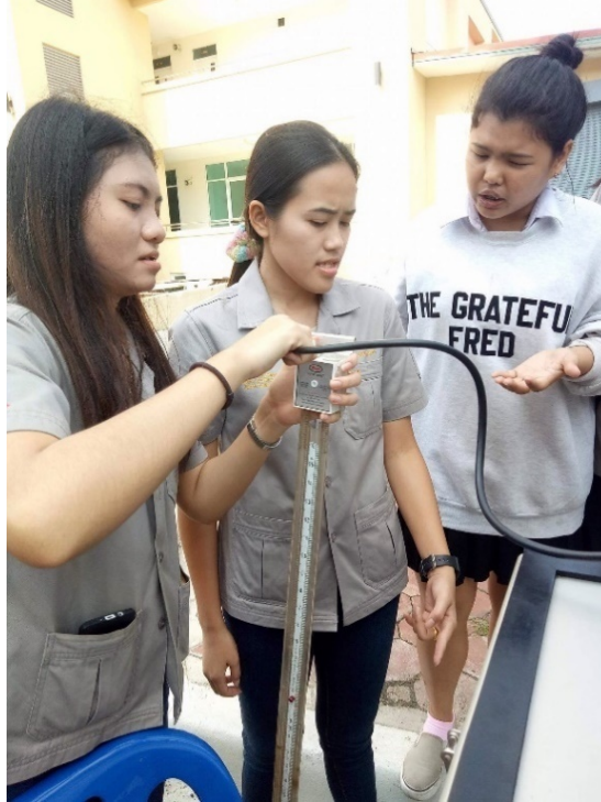
ภาพที่ 8.22 บันทึกค่าความกดอากาศด้วยมาร์นอมิเตอร์ (Manometer Water) ที่มา: นักศึกษาสาขาวิชาเทคโนโลยีความปลอดภัยและอาชีวอนามัย, (2560)
