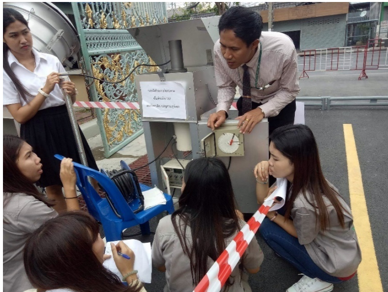
ภาพที่ 8.23 เริ่มสอบเทียบบันทึกค่าจากมาร์นอมิเตอร์ และกระดาษกราฟวงกลม ที่มา: นักศึกษาสาขาวิชาเทคโนโลยีความปลอดภัยและอาชีวอนามัย, (2560)
