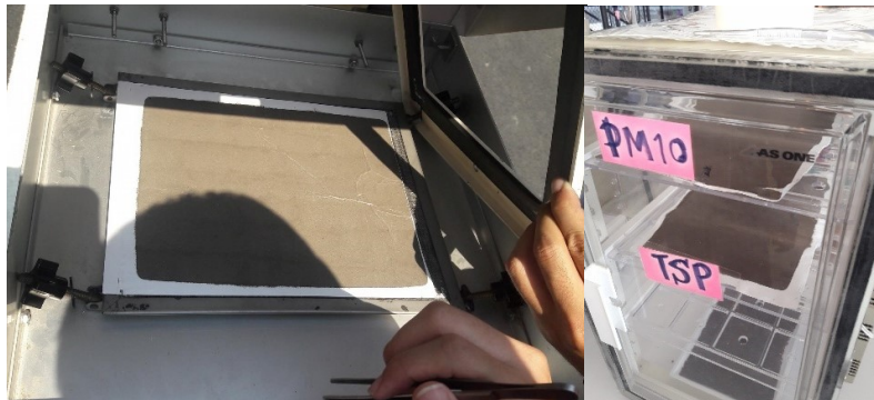
ภาพที่ 8.19 ลักษณะกระดาษกรองหลังเก็บตัวอย่างและนำใส่ตู้การดูความชื้น ที่มา: นักศึกษาสาขาวิชาเทคโนโลยีความปลอดภัยและอาชีวอนามัย, (2560)
