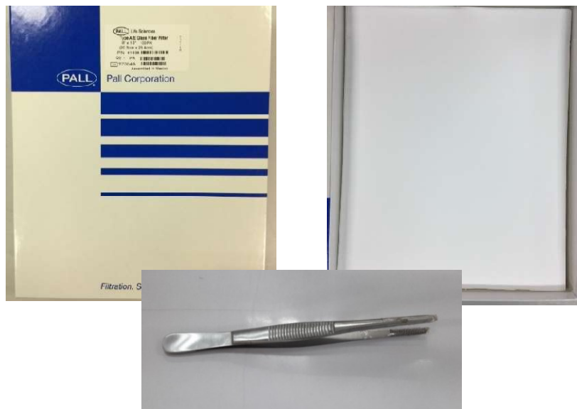
ภาพที่ 8.12 กระดาษกรองใยแก้ว (Glass Fiber Filter) ขนาด 8x10 นิ้ว และปากคีบ (Forceps) ที่มา: ห้องปฏิบัติการ 4257, (2560)
