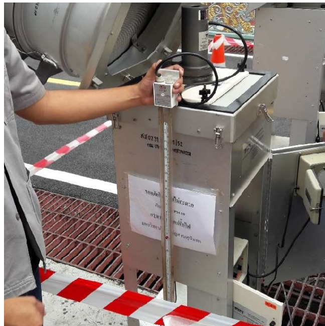
ภาพที่ 8.26 การติดตั้งชุด Orifice กับมาร์นอมิเตอร์ ที่มา: นักศึกษาสาขาวิชาเทคโนโลยีความปลอดภัยและอาชีวอนามัย, (2560)
