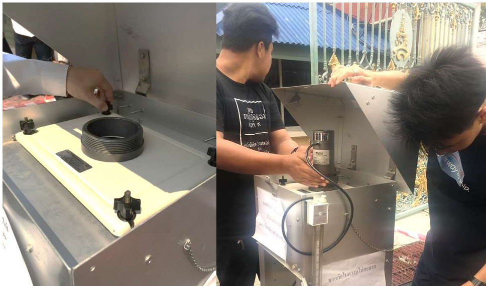
ภาพที่ 8.21 การติดตั้งชุด Orifice กับเครื่อง TSP และต่อชุด Orifice กับมาร์นอมิเตอร์ ที่มา: นักศึกษาสาขาวิชาเทคโนโลยีความปลอดภัยและอาชีวอนามัย, (2560)
