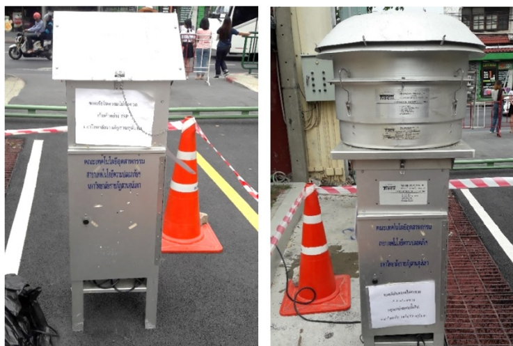
ภาพที่ 8.18 เครื่องเก็บตัวอย่าง TSP (ซ้าย) PM10 (ขวา) เก็บตัวอย่าง 24 ชม. ที่มา: นักศึกษาสาขาวิชาเทคโนโลยีความปลอดภัยและอาชีวอนามัย, (2560)
