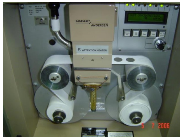
ภาพที่ 8.2 ระบบเบต้าเร (Beta Ray) ภายในสถานีตรวจวัด ที่มา: พัชราวดี สุวรรณธาดา, (2557)
