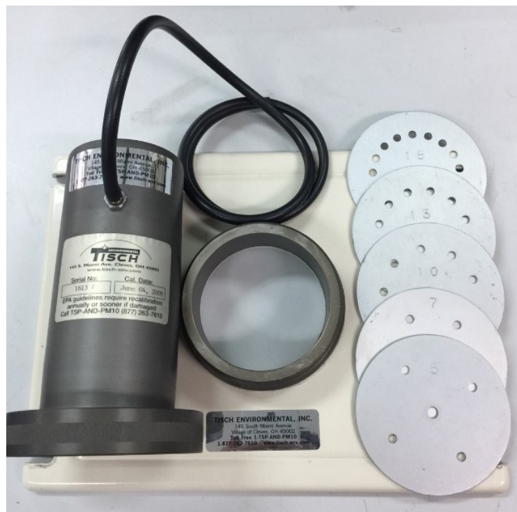
ภาพที่ 8.24 ชุดสอบเทียบ Orifice Flow Rate Transfer Standard ประกอบด้วยกระบอกโลหะ และแผ่นต้านทานการไหลของอากาศจำนวน 5 แผ่น
