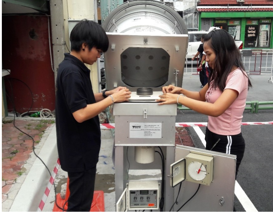
ภาพที่ 8.25 การติดตั้งชุด Orifice กับเครื่อง PM10 ที่มา: นักศึกษาสาขาวิชาเทคโนโลยีความปลอดภัยและอาชีวอนามัย, (2560)
