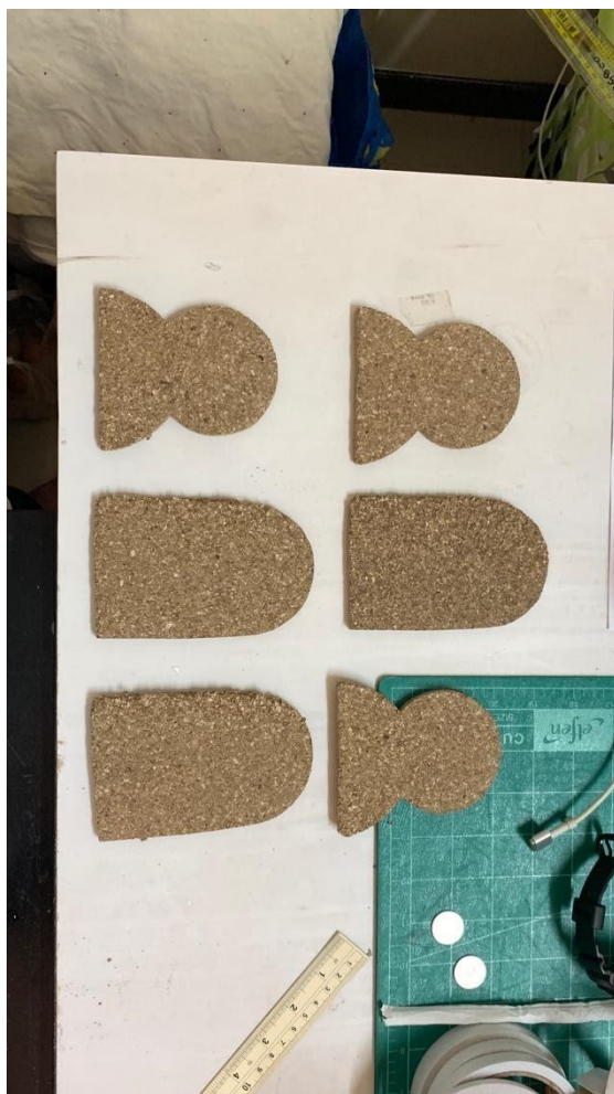
ภาพที่ 4.15 ภาพที่แสดงแผ่นเปลือกแก้วอัดที่นำไปตัดตามแบบ
