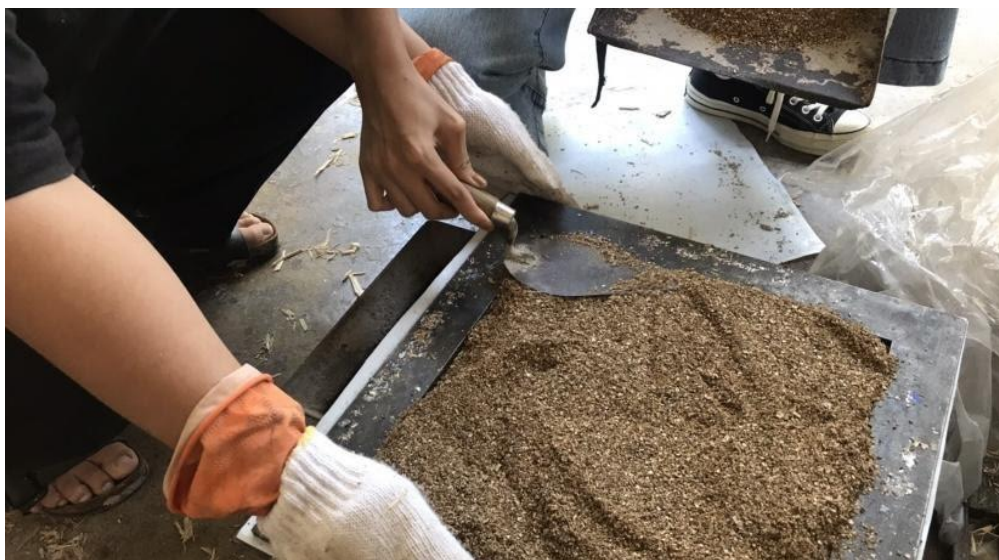
ภาพที่ 4.12 ภาพที่แสดงเปลือกเทใส่แม่พิมพ์
