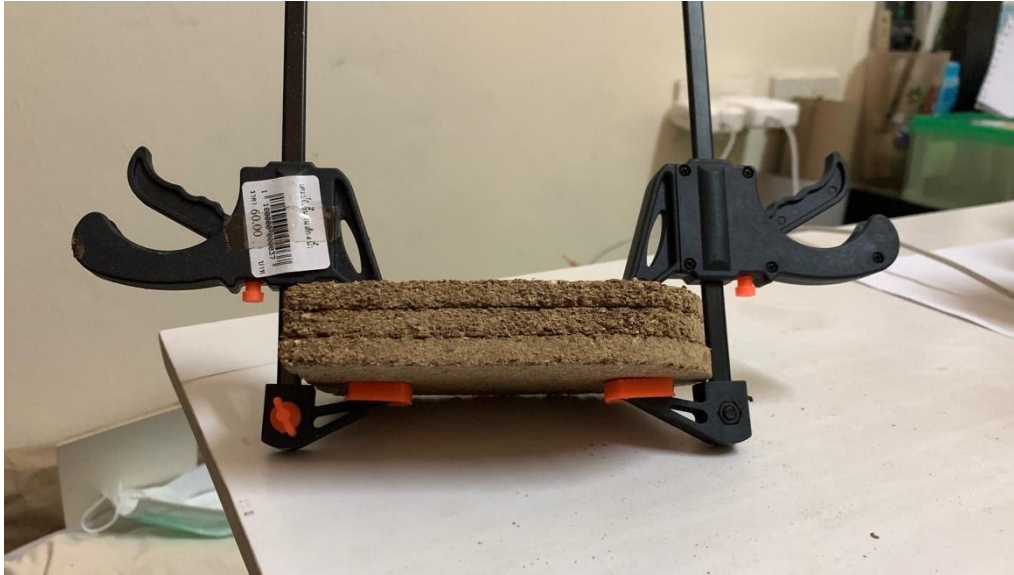
ภาพที่ 4.16 ภาพแสดงการนำแผ่นเปลือกถั่วที่ตัดตามแบบมาอัดให้ได้ความหนา
