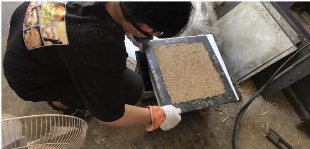
ภาพที่ 4.14 ภาพที่แสดงเอาออกจากเครื่องอัดความร้อน
