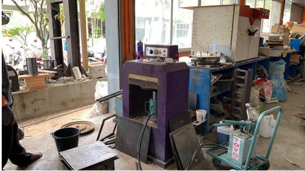
ภาพที่ 4.13 ภาพที่แสดงการนำเปลือกถั่วเข้าเครื่องอัดความร้อน
