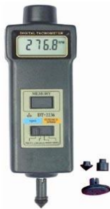
ภาพที่ 10.5 เครื่องวัดความเร็วรอบแบบดิจิตอล ที่มา http://www.cnrinch.com/tachometer.htm
