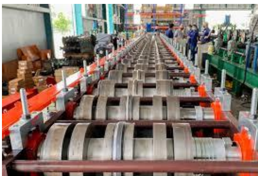
ภาพที่ 3.5 แสดงการรีดขึ้นรูป (Roll Forming)
