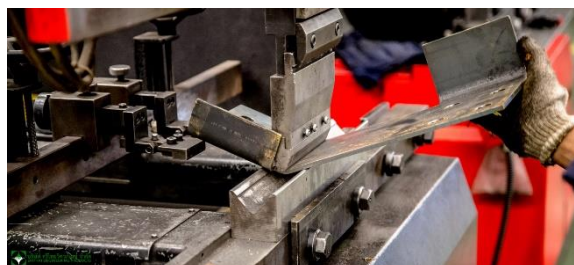
ภาพที่ 3.2 แสดงการพับโลหะ (Bending)
