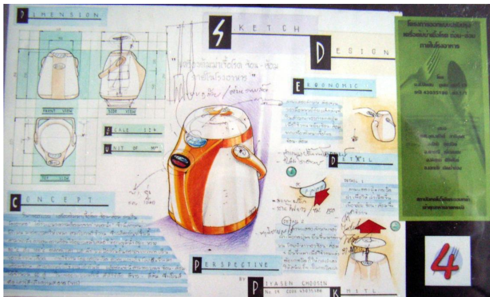
ภาพที่ 82 ตัวอย่างภาพแบบร่างงานออกแบบเครื่องทำความสะอาดช้อน-ส้อมในโรงอาหาร
